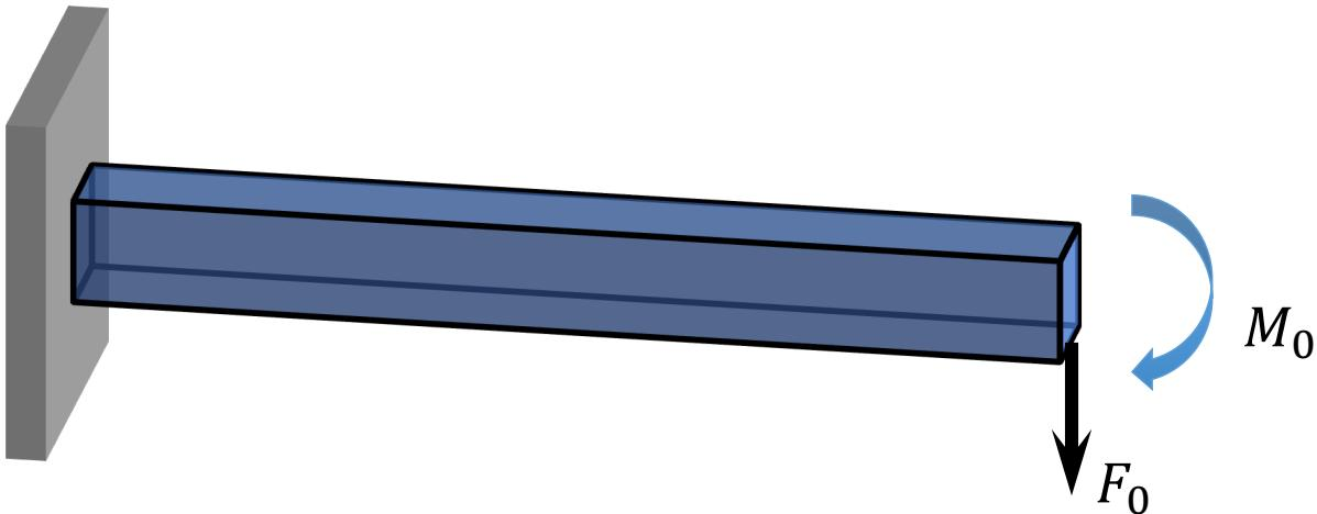
Calculons l'énergie de déformation de cette poutre de deux façons:
